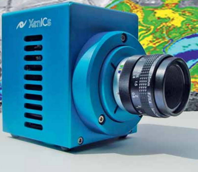
Bild 1. Die digitale NIR-Kamera Xeva-2.5-320 mit vierstufig thermoelektrisch gekühltem FPA und einer Auflösung von 320 x 256 Pixeln überstreicht den erweiterten NIR-Bereich von 0,85 bis 2,5 µm Wellenlänge
